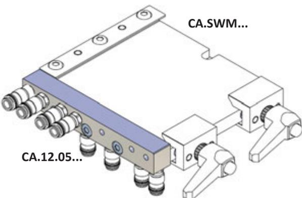
. Luftanschlußleiste Greiferwechselsystem für CA.SWM
